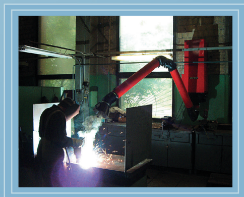
Электрофильтр ЭФВА-1-24В (настенный). Завод экспериментальных машин г. Москва (улавливание сварочных аэрозолей)
