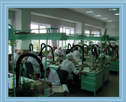
Монтажный участок, оборудованный МПВУ «Пластик-75»
